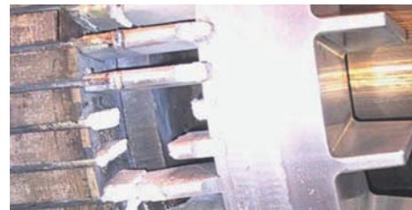
Rys. 10. Przykładowe uszkodzenie prętów klatki wirnika silnika 800 kW
