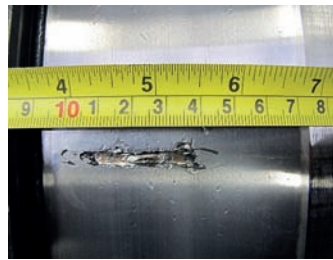
Rys. 8. Widoczne głębokie złuszczenie bieżni oraz ślady zawalcowania wyrwanych fragmentów bieżni
