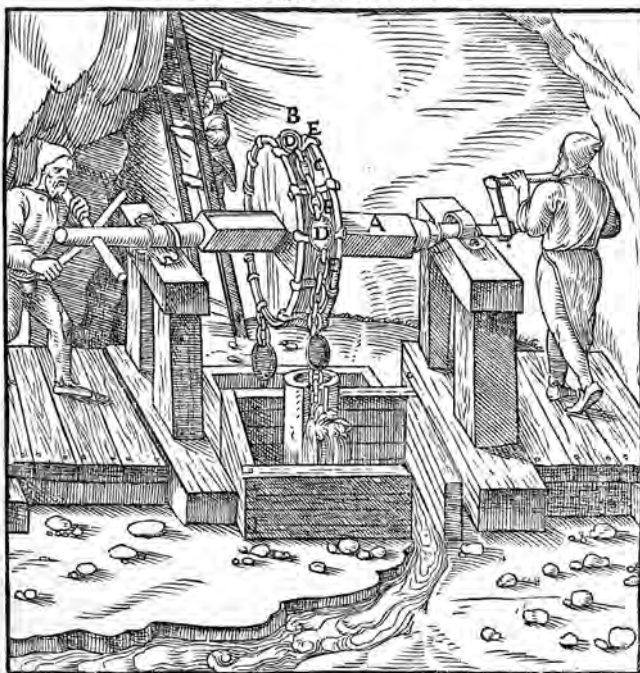
Fot. 2. Dawne systemy pompowania wody wg Agricoli
