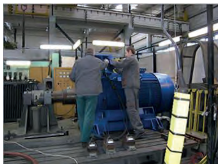
Fot. 2. Pomiar momentu rozruchowego silnika o mocy 1 MW i napięciu 6 kV
