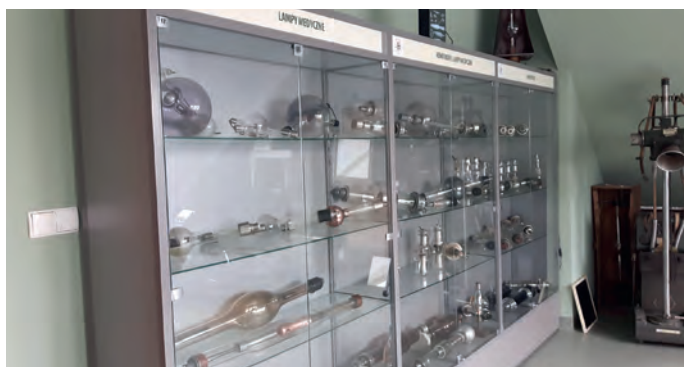
Fot. 5. Najstarsze lampy rentgenowskie (gazowane z zimną katodą) oraz kenotrony (diody prostownicze wysokiego napięcia)
