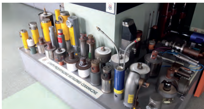
Fot. 3. LAMPY metalowo-ceramiczne do zastosowań przemysłowych
