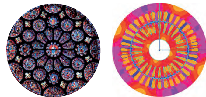
Rys. 22. Witraż – rozeta z fasady katedry w Amiens (Francja) oraz siatka dyskretyzacyjna „blach” stojana i wirnika silnika indukcyjnego
