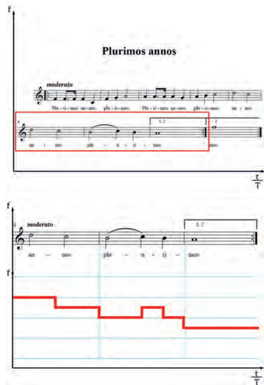
Rys. 27. Notacja muzyczna to umowny zapis charakterystyki czasowej częstotliwości jako funkcji odcinkami stałej
